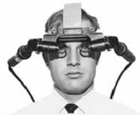
Figura 1.2. Head-mounted display desenvolvido por Ivan Sutherland.
