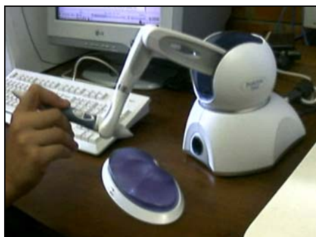
Figura 3.14 – Dispositivo háptico 6DOF e retorno de força em 3DOF.
