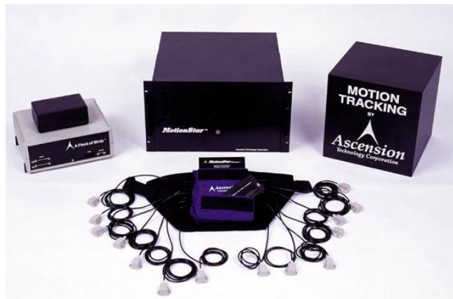
Figura 3.4 - Componentes de um dispositivo de trajetória magnético [http://www.ascension-tech.com].
