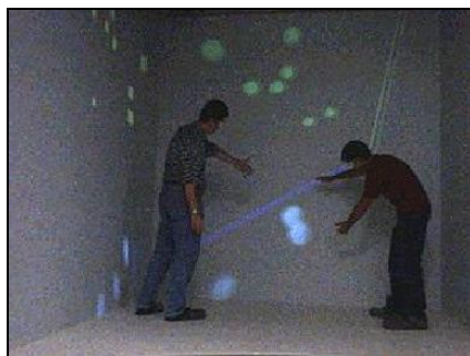
Figura 3.12 – Ambiente de visualização composto por 5 telas de projeção: chão e paredes.
